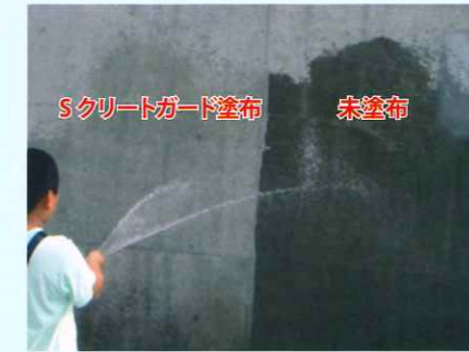
試験施工から10年経過後の追加試験の様子。10年経過後も撥水性能を保っています。
